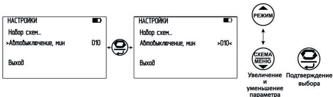
Рисунок 2.2 – Настройка времени автоотключения
