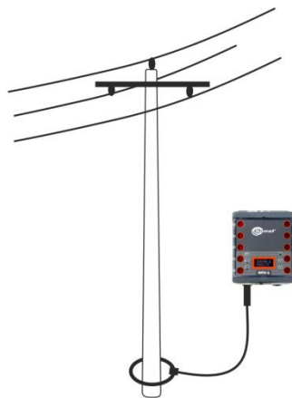
Рис.6. Работа прибора с использованием одних токовых клещей
