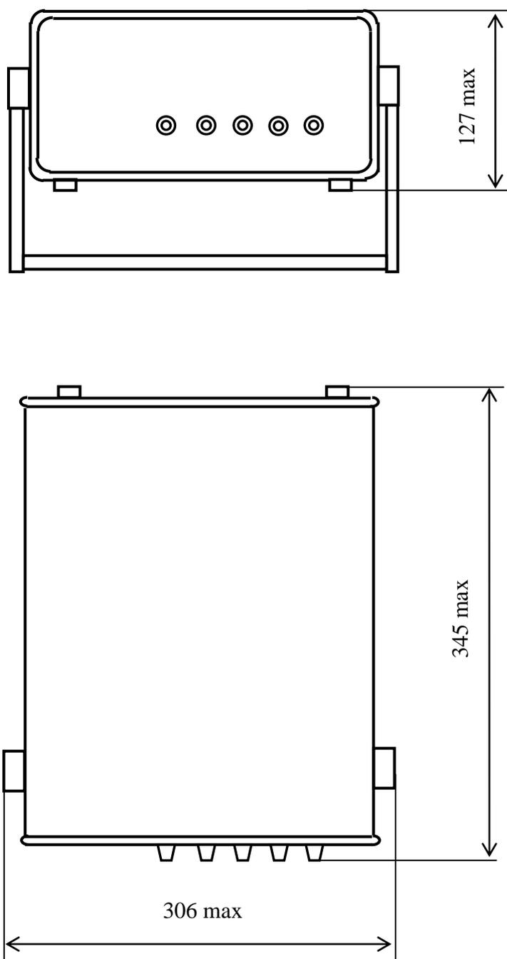
Рисунок А.1 - Габаритные размеры генератора
