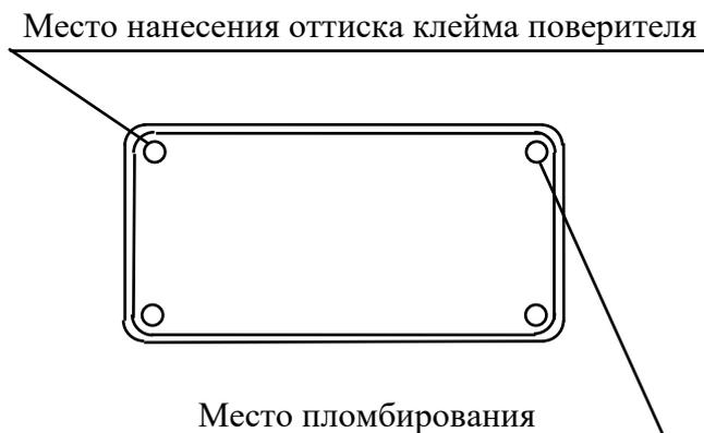
Рисунок 3 - Задняя панель генератора.
