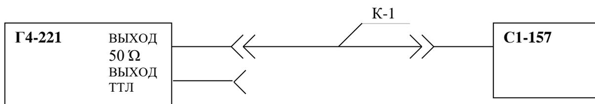
Рисунок 5 - Схема соединения приборов для опробования генератора
