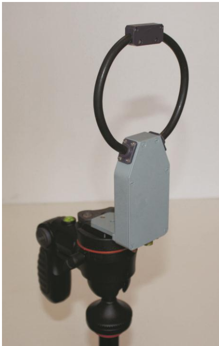
Фото 1. Вариант крепления антенны П6-219 на фотоштатив
