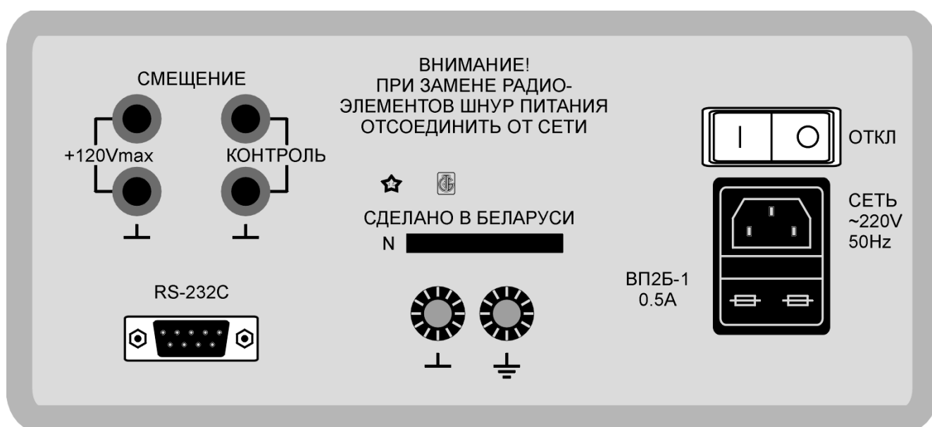
Рисунок 2.2 – Задняя панель прибора. Расположение органов управления
