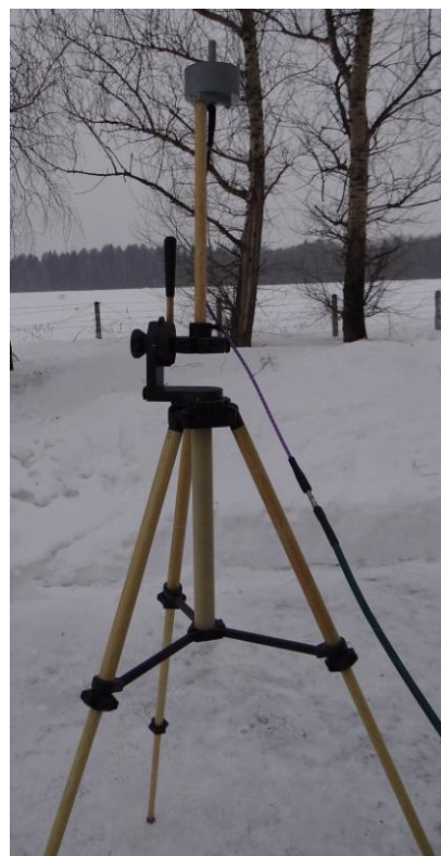
Фото2. Антенна АС7.24 на диэлектрическом штативе
