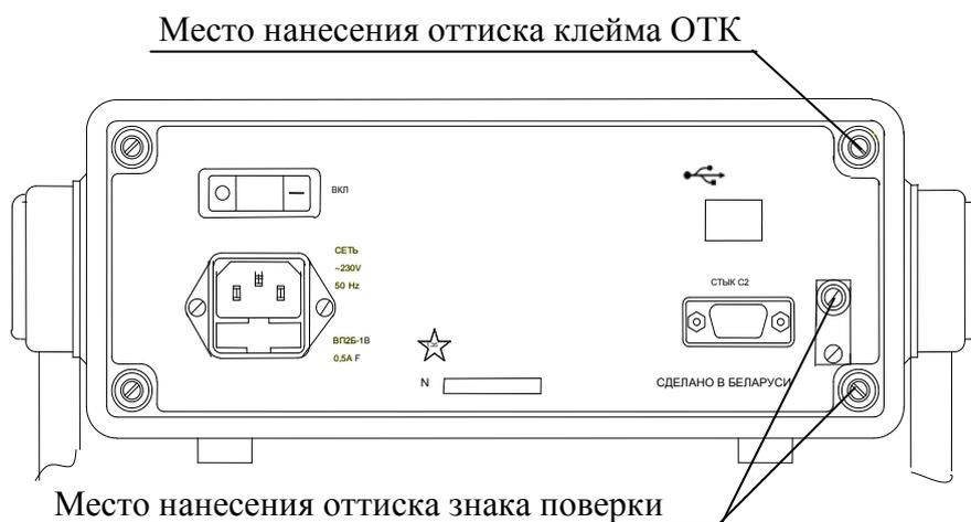
Рисунок 4 - Места пломбирования и нанесения оттиска клейма поверителя
