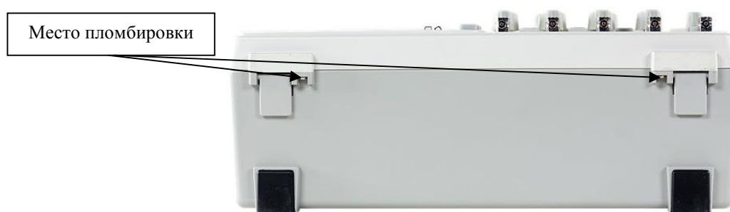
Рисунок 7 - Схема пломбировки осциллографов
