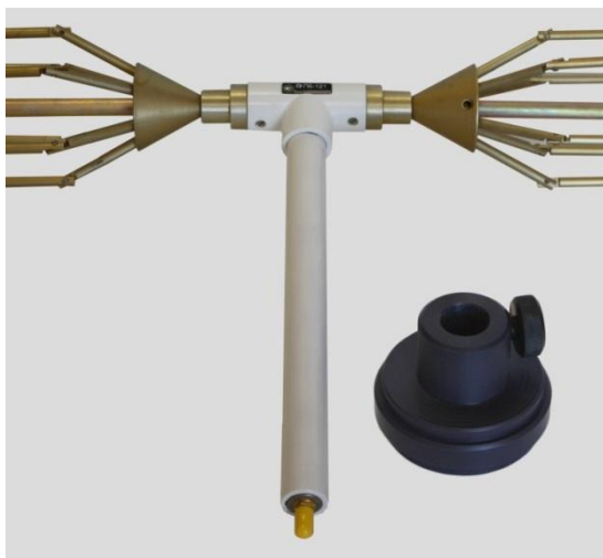
Фотографии 5 и 6. На примере антенны П6-121 с узлом крепления на диэлектрическом штативе (ШАД-01)
