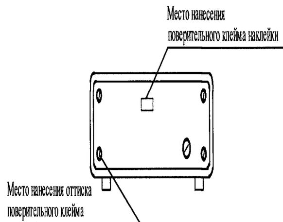
Рисунок А.1 – Место нанесения оттиска поверительного клейма и поверительного клейма наклейки на задней панели вольтметров
